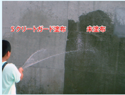
試験施工から10年経過後の追加試験の様子。10年経過後も撥水性能を保っています。
